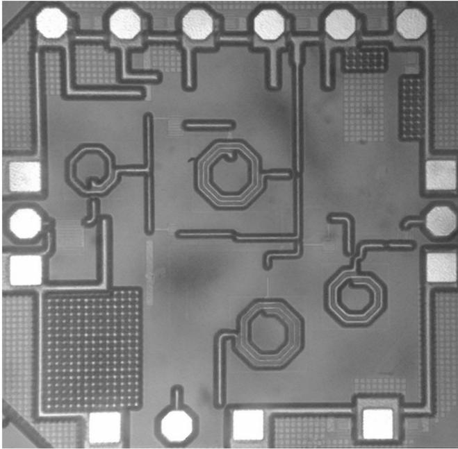
Fig. 11. Photograph of UWB LNA IC.
